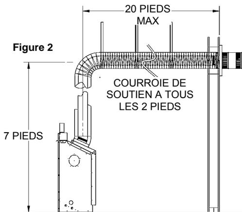
**Important :** La distance minimale entre le tuyau d'évacuation et les matières combustibles est de 1po (2.5cm)
