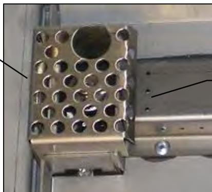
\*L’écran de veilleuse doit être inspecté visuellement une fois par mois pour voir s’il y a signe de détérioration due à l’exposition à la flamme. Remplacez si nécessaire.
