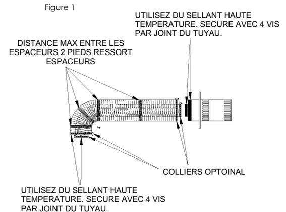
**N.B.** Il est primordial, pour assurer le fonctionnement sécuritaire et approprié de ce foyer, que tous les joints du conduit et de sa doublure intérieure soit scellés avec une bonne quantité de calfeutrant. N'utilisez que les rubans et scellant recommandés dans ce manuel. Scellant Mill Pac.
