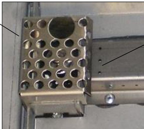
\*L'écran de veilleuse doit être inspecté visuellement une fois par mois pour voir s'il y a un signe de détérioration due à l'exposition à la flamme. Remplacez si nécessaire.
