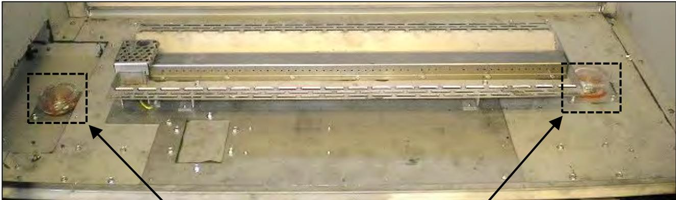
**ÉTAPE 1 :** Enlevez les couvercles et installez les lampes dans la chambre de combustion. Appliquez du scellant neuf (Mill-Pac).
