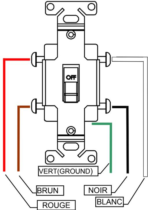
Faisceau de câbles de 10pi pour interrupteur bipolaire du système Millivolt. Branchez l'interrupteur bipolaire tel qu'indiqué. Un câble d'extension de 20pi peut être commandé. Voir la section Branchements pour l'installation de l'extension.
