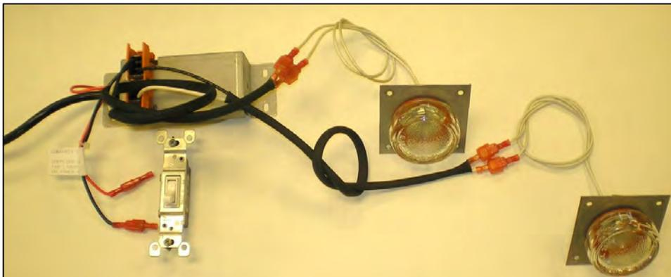
**ÉTAPE 2 :** Branchez les fils de la lampe aux fils chemisés du transformateur. Branchez les fils de l'interrupteur aux fils noir et rouge au transformateur, ou branchez les fils noir et rouge du transformateur ensemble si le réceptacle 120V est contrôlé par un interrupteur.
