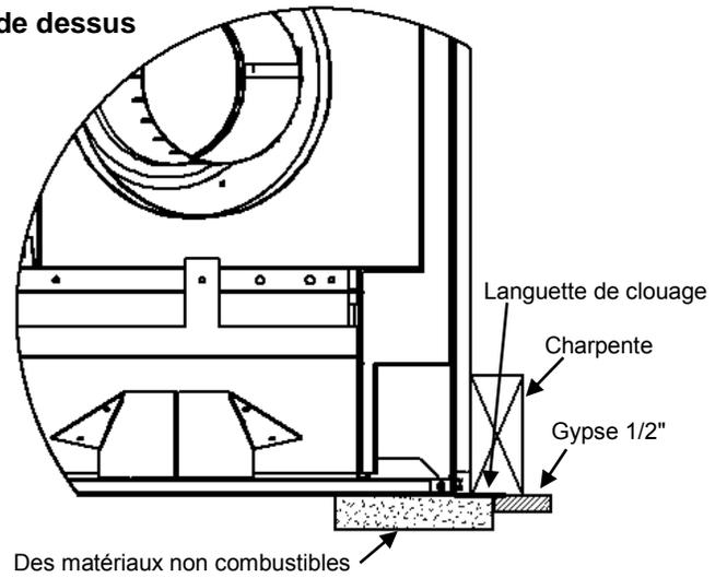
Les languettes de clouage doivent être pivotées à 180° et pliées sur la charpente
