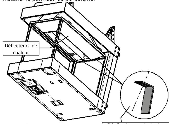
Dépliez les crochets de retenue pour les éloigner du mur. Dépliez-les pour fixer la doublure.
