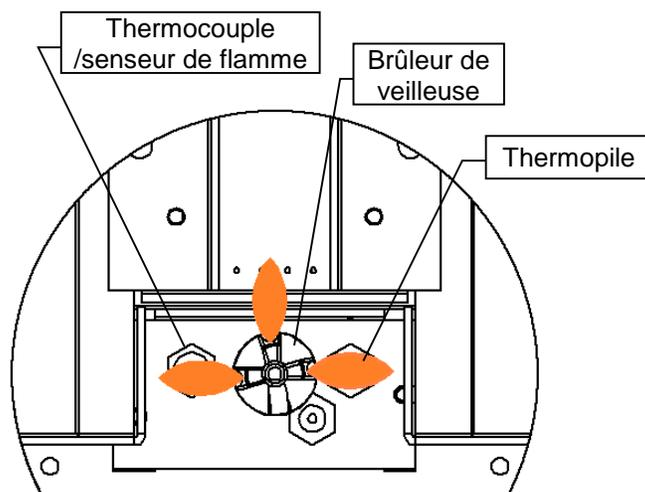
Il est recommandé d'allumer l'appareil au moins une fois par mois et d'en inspecter le patron de flamme pour vous assurer qu'il n'y a pas de problème de tube de brûleur. (Les flammes doivent ressembler à la photo ci-dessus).
