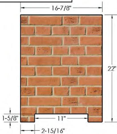
**N.B. :** La doublure de brique doit être installée **AVANT** le M42LG.
