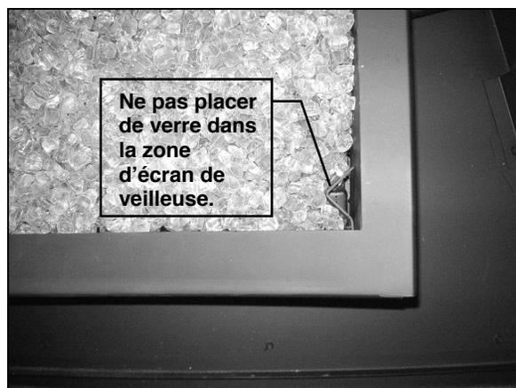
**Étape 3 :** Pour permettre un bon fonctionnement du foyer, aucune braise de verre ne doit être placée dans cette zone.
