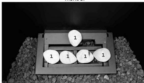
**ÉTAPE 4 :** Placez les roches #1 sur le brûleur, tel qu'illustré. Ne pas placer de roches sur les tubes du brûleur.
